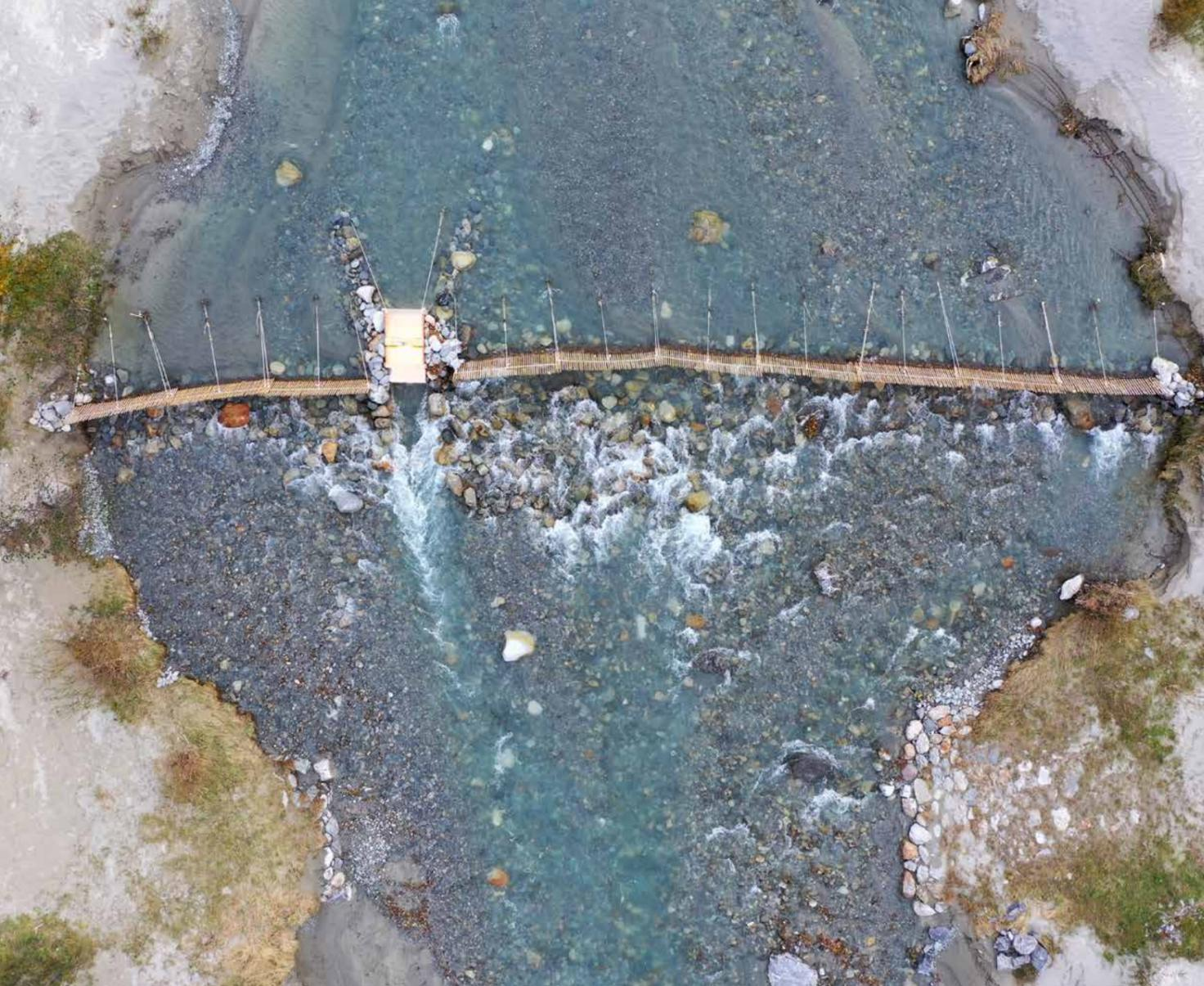
Mit einer Absperrung über die gesamte Flussbreite werden die Fische in eine Zählreuse gelotst.
